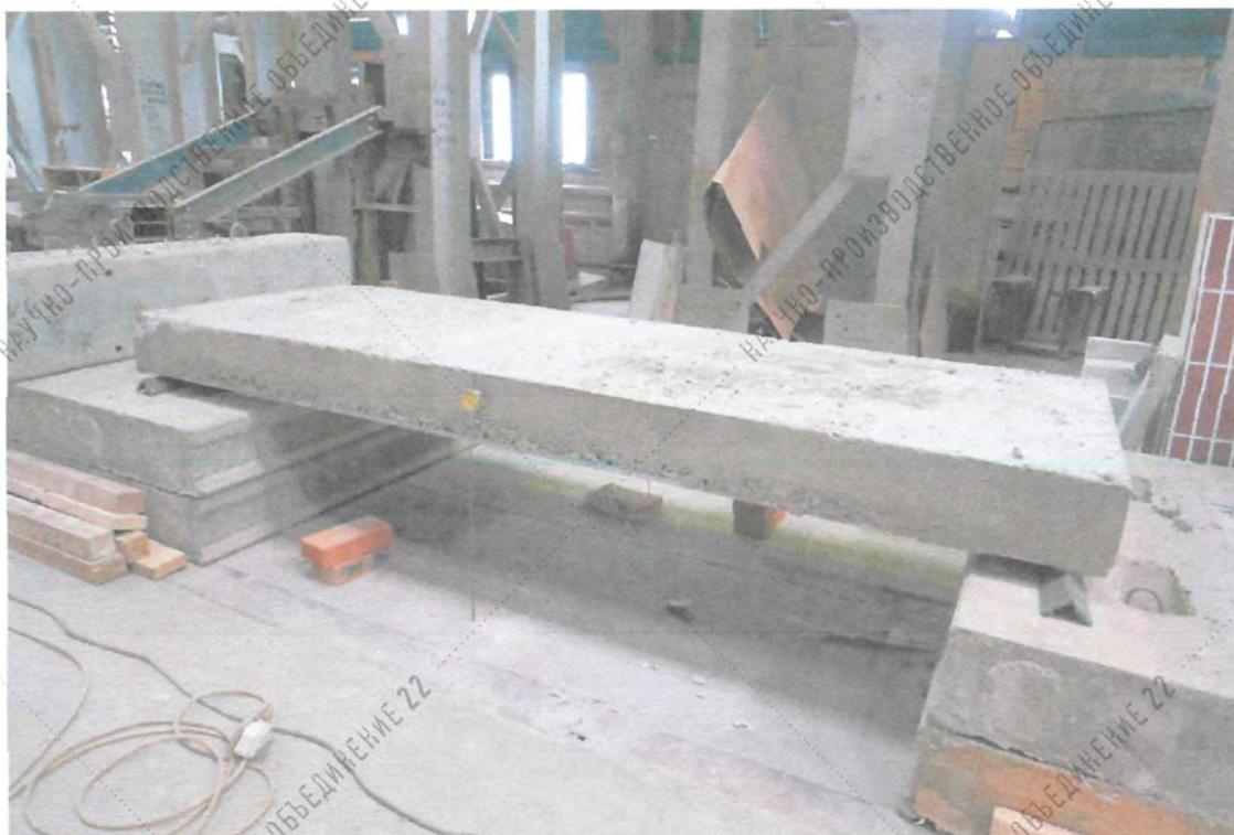
Рисунок 4.1 Общий вид опытных образцов плит перекрытий марок БПД (а) и БПС (б) до начала испытаний
